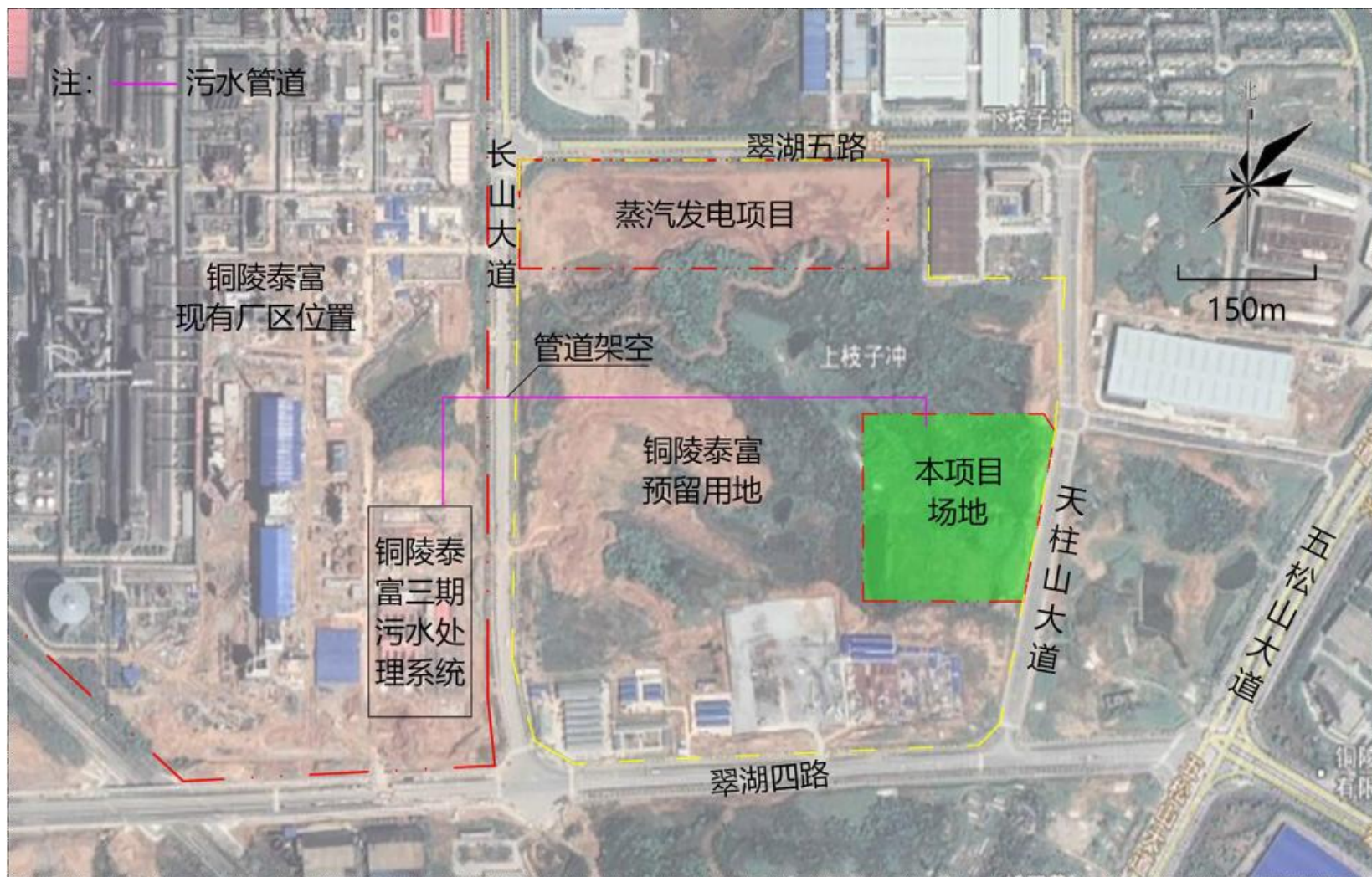
附件 4、项目依托工程污水管道布设图
