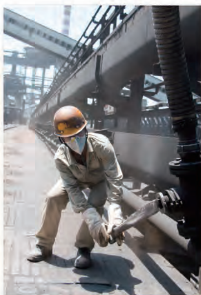
●为保证煤气进入燃烧室，达到加速和充分燃烧的目的，炼焦小伙正奋力打开煤气助燃旋塞。
