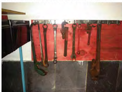
现场改善图片（化产分厂中石电工班）： 不同工具使用挂钩分开存放，避免重叠； 后期需补充物品行迹定位标识。
