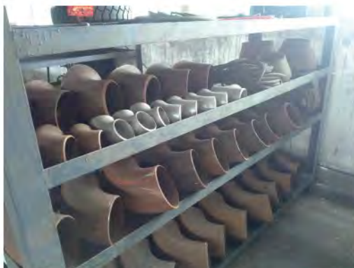
现场改善图片（顶装焦炉中石综合仓库）：弯头等按不同类型、大小分开存放整齐，物品取用快捷，但物品缺少标识。
