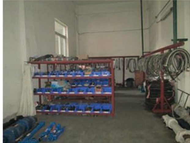
改善中图片（炼焦分厂顶装炉中石维修点）：现场各类备件分类、分层、定置摆放，卷装物制作专用货架存放，现场无不要物；后期仍需加强日常管理，划定各种类备件存放区及待存放备件区域 ▲
